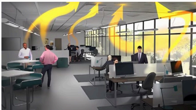
Di giorno il soffitto assorbe il calore in eccesso della stanza: il nucleo fonde a temperatura costante e l'ambiente non si surriscalda.
